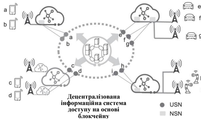
Рис. 2. Децентралізована та орієнтована на користувача архітектура сегменту інформаційної мережі радіодоступу 6G
